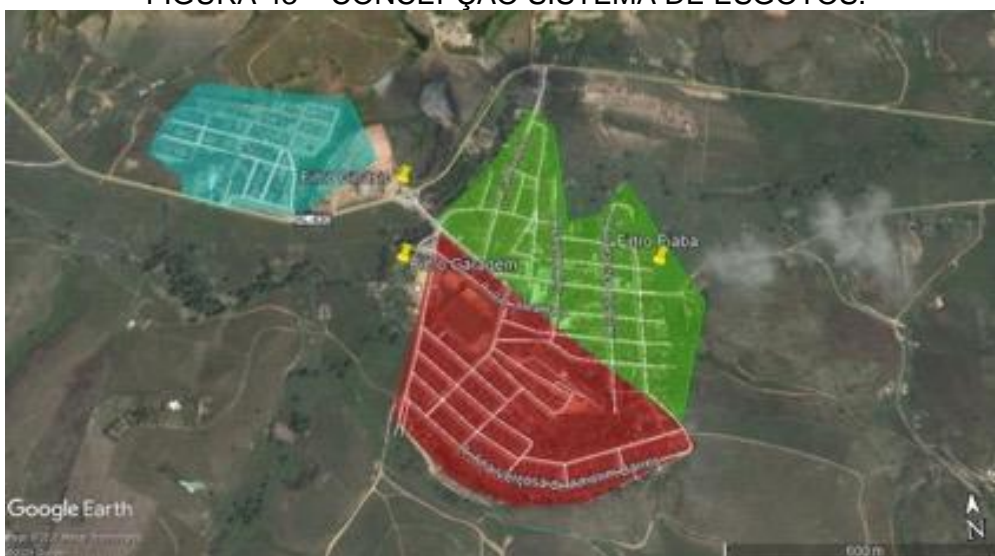
FIGURA 43 – CONCEPÇÃO SISTEMA DE ESGOTOS.
