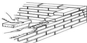
**Figura 6 - Colocação da argamassa de assentamento**
