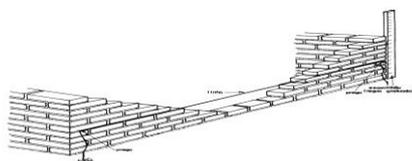
**Figura 4 - Detalhe do nivelamento da elevação da alvenaria.**
