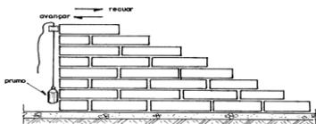
**Figura 5 - Detalhe do prumo das alvenarias.**
