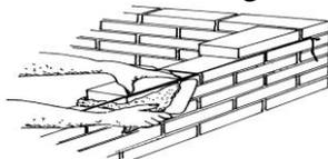
**Figura 8 - Retirada do excesso de argamassa.**
